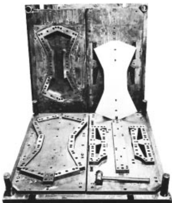
Outillage de découpe réalisé au départ de plaques pré rectifiées ARNE.
