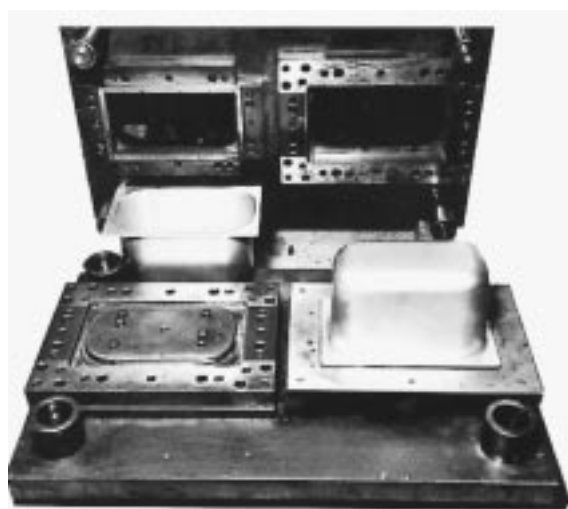
Outil d'ébarbage et de pliage en acier ARNE pour produire des récipients en tôle inox d'épaisseur 0,914 mm et de dimensions 254 x 152 x 203 mm.
